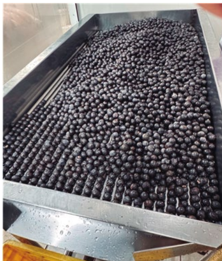
Figura 3: Etapa de peneiramento do açaí.
