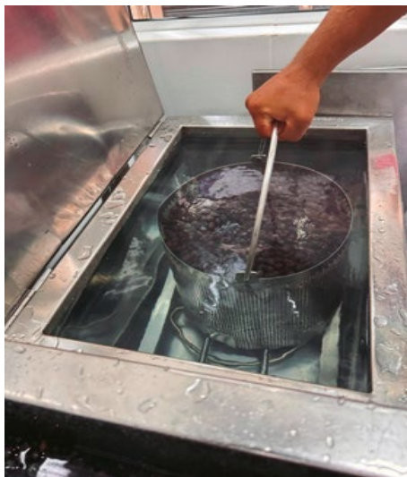
Figura 5: Branqueamento do açaí, em água potável aquecida a 80 °C por 10 segundos.
