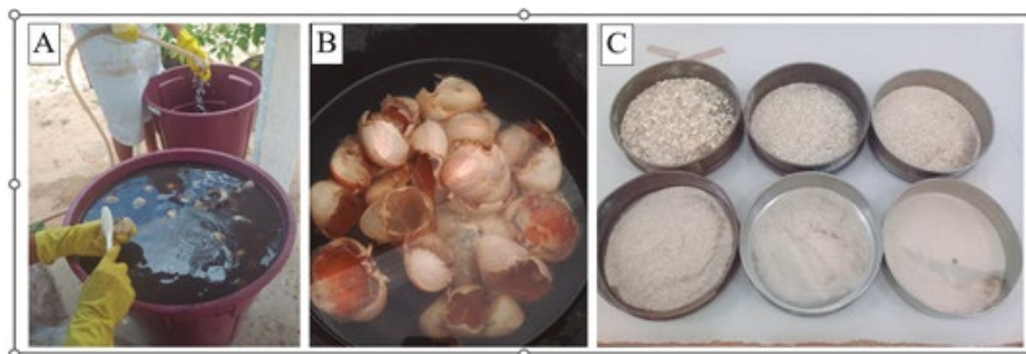
Figura 01: Processos de Lavagem (A), Imersão em hipoclorito de sódio (B) e análise granulométrica (C).
